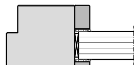
Friesbreite Lichtausschnitt mit beidseitiger Glasleiste
