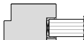
Friesbreite Lichtausschnitt mit einseitiger Glasleiste
