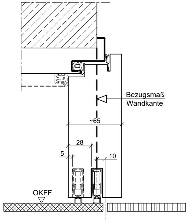
HW65-aufliegend mit Doppelfalz in Stahlzarge
