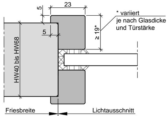
aufliegende Glasleiste "Typ E" HW40 bis HW68
