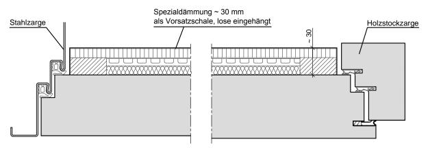
Schallschutzaufdopplung d= 30 mm
