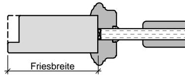
Füllungsplatte mit profilierter Glasleiste
