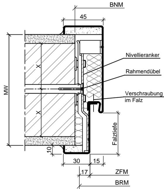
2-schalige Stahlfassungszarge mit Nivellierankerbefestigung
