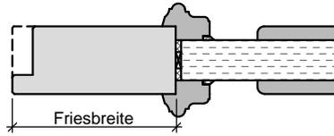
Füllungsplatte mit profilierter Glasleiste
