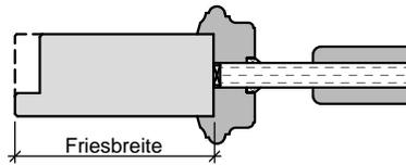
Füllungsplatte mit profilierter Glasleiste
