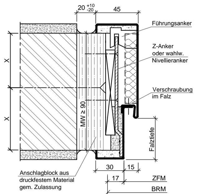
2-schalige Stahlfassungszarge Z-Ankerbefestigung mit Anschlagblock in Massivwand
