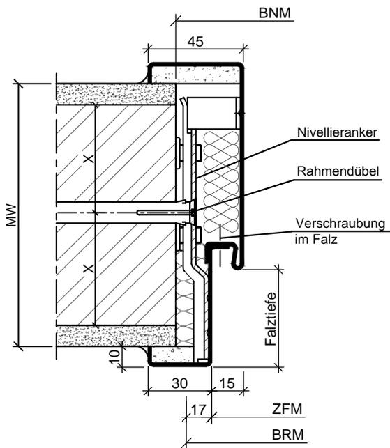
2-schalige Stahlfassungszarge mit Nivellierankerbefestigung
