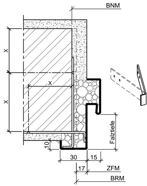
Stahleckzarge mit doppeltem Schraubanker
