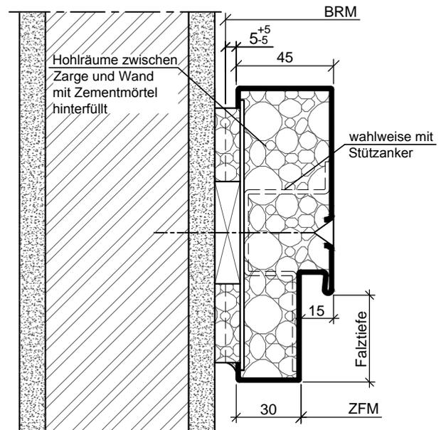
Blockzarge mit Rahmendübelbefestigung in Parallelwandmontage
