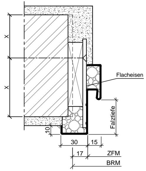
Stahleckzarge mit einfachem Schraubanker
