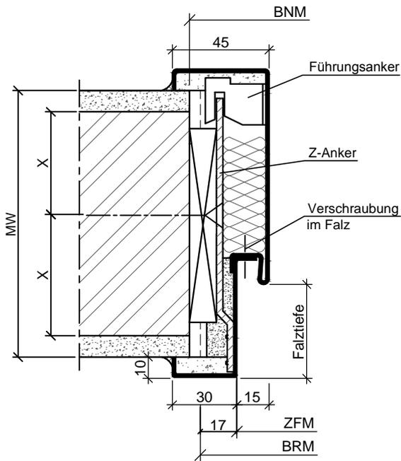
2-schalige Stahlfassungszarge mit Z-Ankerbefestigung in Massivwand
